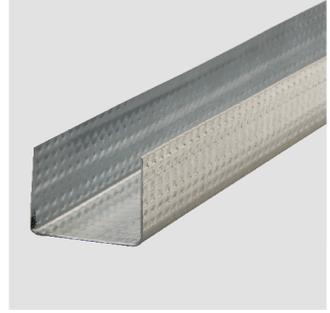
Paslanmayı önlemek için sıcak daldırma yöntemi ile galvaniz kaplanmış 0,40; 0,45; 0,50 ve 0,60 mm kalınlığında karbon çeliği sacdan, soğuk şekil verme yöntemiyle imal edilmiştir.
